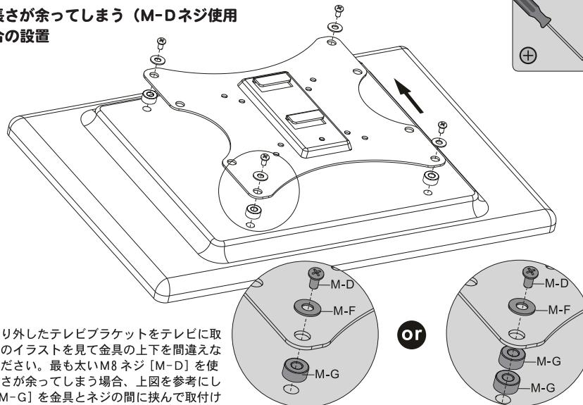
ステップ1で取り外したテレビブラケットをテレビに取付します。上記のイラストを見て金具の上下を間違えないようにしてください。最も太いM8ネジ【M-D】を使用してネジの長さが余ってしまう場合、上図を参考にしてスペーサー【M-G】を金具とネジの間に挟んで取付けをします。
