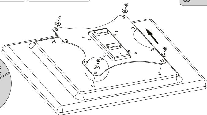
ステップ 1で取り外したテレビブラケットをテレビに取付します。上記のイラストを見て金具の上下を間違えないようにしてください。ネジ穴を合わせて、ネジ [M-A ~ D] とワッシャー [M-E, F] で取付をします。
