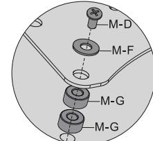
ステップ 1 で取り外したテレビブラケットをテレビに取付します。上記のイラストを見て金具の上下を間違えないようにしてください。最も太いM8ネジ [M-D] を使用してネジの長さが余ってしまう場合、上図を参考にしてスペーサー [M-G] を金具とネジの間に挟んで取付けをします。
