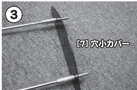
※アルミ薄カバー穴小 [7] にパイプ短を差し込みます。
